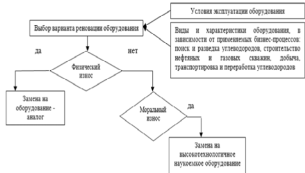
Рис. 1. Блок схема алгоритма методики выбора варианта реновации оборудования предприятий нефтегазового комплекса.
